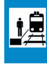
При приближающемся подвижном составе отойдите на обочину на расстояние 2,5 м от крайнего рельса или остановитесь в середине междупутья. Переходить для пропуска поезда на соседний путь и находиться на нем запрещается.
