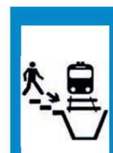
При обходе вагонов или локомотивов, стоящих на путях, следует переходить путь на расстоянии не менее 5 м от автосцепки крайнего вагона или локомотива и проходить между расцепленными вагонами, если расстояние между ними не менее 10 м. Но сначала убедитесь, что с обеих сторон по соседнему пути не движется состав, локомотив.
