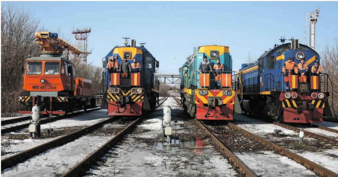
Подвижной состав ЖДЦ комбината включает 4 тепловоза, 2 железнодорожных крана, 1 мотовоз погрузочно-транспортный и 1 путевую машину для смены шпал.
