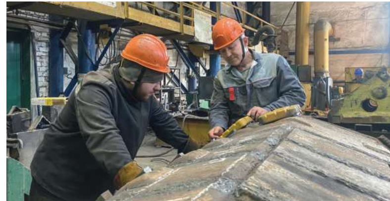
Ремонтная бригада производит контрольные замеры ковша ПДМ.
