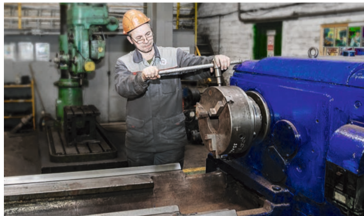
Токарь РМЦ Марат Сайфутдинов оценил заводскую комплектацию и преимущества токарно-винторезного станка 1А-64
