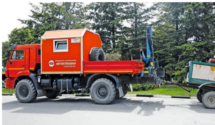
Мобильный сварочный пост готов к работе.
