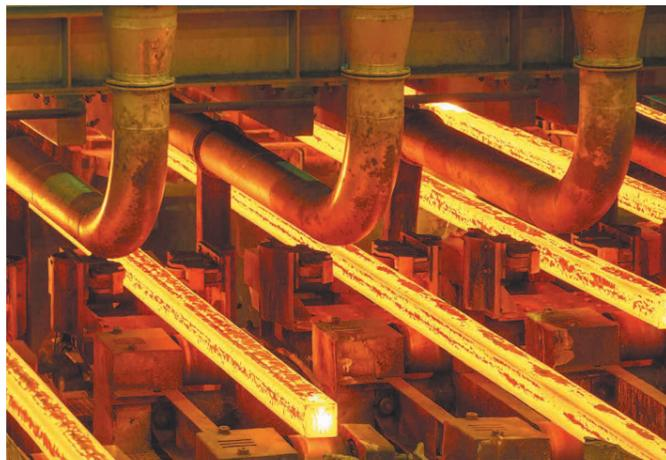
↑ Жидкая сталь разливается на шестиручье машины непрерывного литья заготовок.
