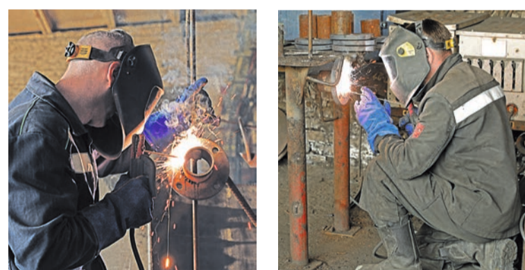
Фланец + труба = заготовка для трубопровода.
