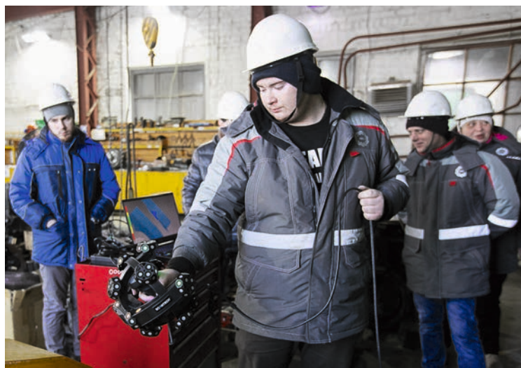
Инженер-конструктор Никита Крылов определяет пространственное положение точек на поверхности детали с помощью ручного лазерного сканера
