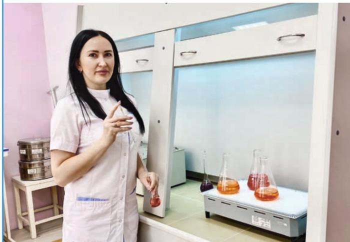
– Мы используем его в работе с концентрированными кислотами и щелочами, с выпариванием концентрированных кислот. Шкаф всасывает воздух из рабочего пространства и выводит за пределы лаборатории, – объясняет инженер Елена Несветаева.
