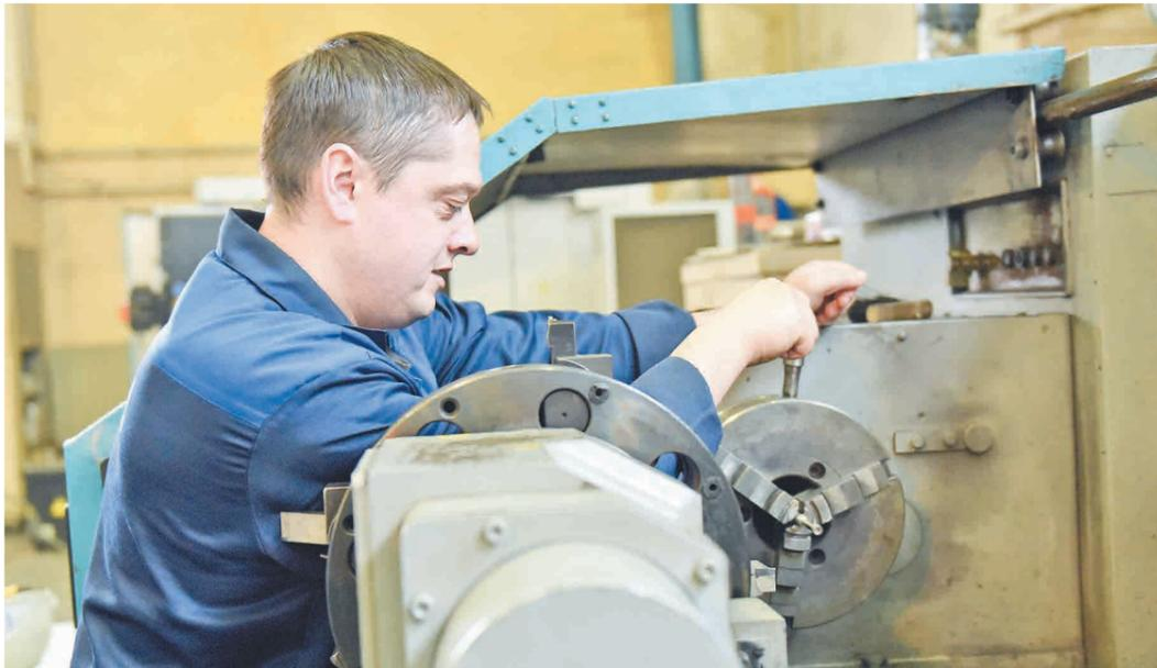
**О**н предложил изготовить образцы из тугоплавких материалов на патронно-центровом токарном станке. Ранее обработка проводилась на токарно-винторезном универсальном
